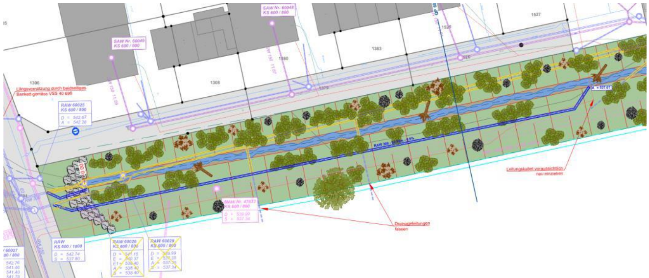
Abbildung 6: Neue Sauberwasserleitung (blaue Leitung) parallel zur Bachachse (P626) zwecks Entwässerung bestehender Drainageleitungen
