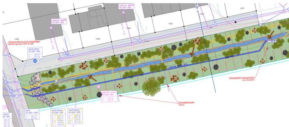
Abbildung 22 Neue Sauberwasserleitung (blaue Leitung) parallel zur Bachachse (P626) zwecks Entwässerung bestehender Drainageleitungen
