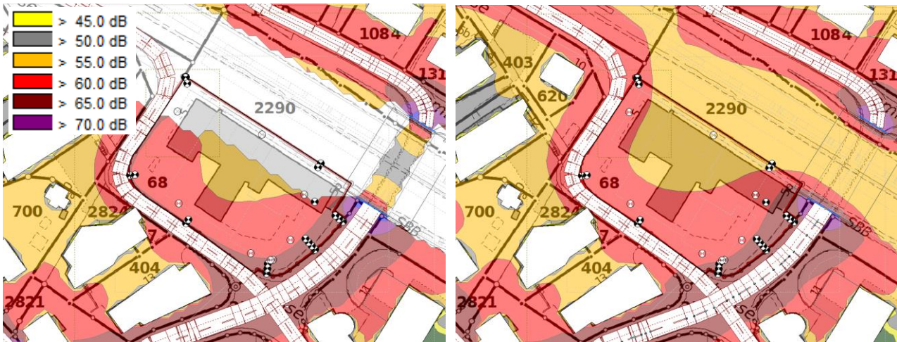
Abbildung 4 Strassenverkehrslärm Tag (aktualisiert) Raster mit Flächen gleichen Schallpegels: links Niveau 0 (552.5 m ü. M.), rechts Niveau 1 (555.5 m ü. M.) IGW Tag = 65 dB
