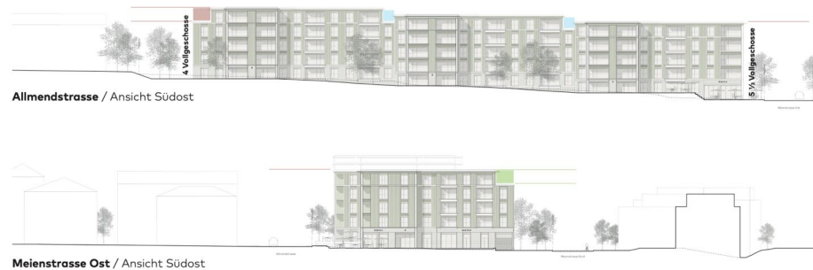
Abbildung 13 Vertikale Staffelung der Gebäude, Fassaden und Schnitte
